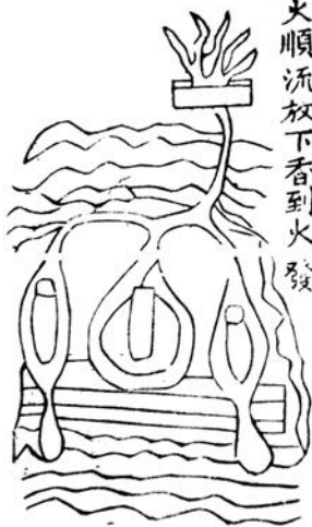
Китайская морская мина эпохи династии Мин (рисунок и описание из трактата Холунцзин)
